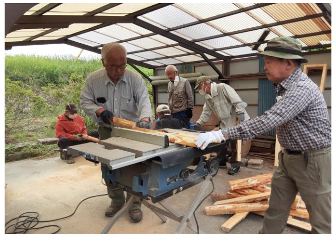
丸鋸盤による切断作業
