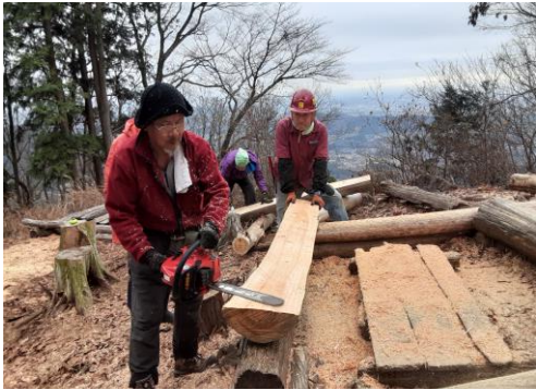
丸太材の半割作業(上写真)
