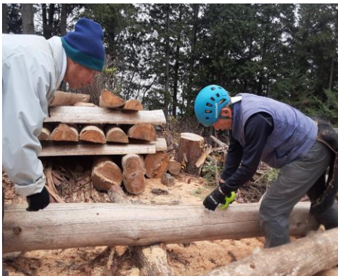
半割の線引き(上写真)
